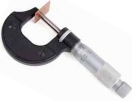
الشكل (3): قياس سُمْكِ صفيحة باستخدام الميكروميتر.
