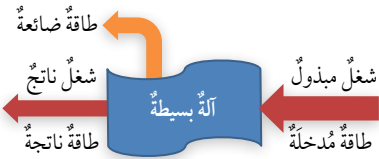
الشكل (14): تحولات الطاقة في الآلة البسيطة.
