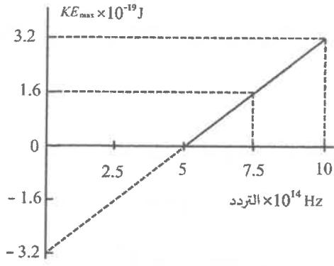
37- يوضح الشكل البياني المجاور العلاقة بين الطاقة الحركية العظمى للإلكترونات المُنبعة في خلية كهربائية، وترتّد الضوء الساقط عليها. عندما يكون الضوء الساقط ( $1 \times 10^{15} \text{ Hz}$ ، فإن جهد الإيقاف
