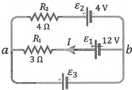
19- مقدار القوة الدافعة الكهربائية ( $\epsilon_3$ ) بوحدة فولت (V) يساوي:
