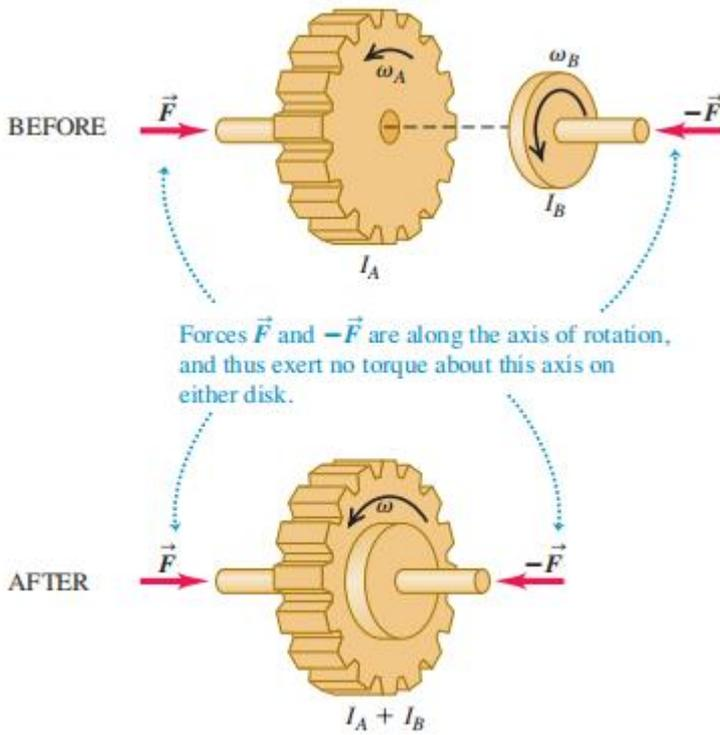
في الشكل المجاور قرصان مصمتان لهما عزم قصور ذاتي  $(I_A)$  و  $(I_B)$  ، بداية يتحرك كل منهما بشكل منفصل بسرعة زاوية  $(\omega_A)$  و  $(\omega_B)$  وبنفس الاتجاه، إذا التحم الجسمان وتحركا بسرعة زاوية واحدة  $(\omega)$ ، جد مقدار هذه السرعة؟
