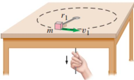
تدور كرة صغيرة كتلتها ( $m$ ) مثبتة في نهاية خيط في مسار دائري على سطح طاولة أفقي أملس، ويمر الطرف الآخر للخيط عبر ثقب في سطح الطاولة كما في الشكل المجاور. إذا كانت تدور بسرعة ( $v_1 = 2.4 \text{ m/s}$ ) في مسار دائري نصف قطره ( $0.8 \text{ m}$ ) ثم سحب الخيط ببطء عبر الثقب، بحيث يقل نصف القطر إلى ( $0.48 \text{ m}$ ) ، فكم تصبح سرعة الكرة ( $v_2$ )؟
