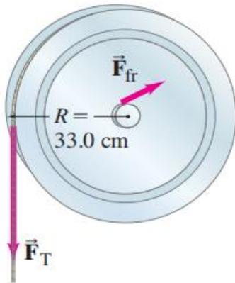
في الشكل المجاور حبل ملفوف حول بكرة يشدها للأسفل بقوة مقدارها  $(F_T = 15\text{ N})$  ، قابلة للدوران حول محور يمر بمركزها وعمودي على مستوى الصفحة كتلتها  $(M = 4.0\text{ kg})$  ونصف قطرها  $(R = 33.0\text{ cm})$  ويؤثر عليها قوة احتكاك مع محور الدوران عزمها  $(\tau_{fr} = 1.10\text{ N.m})$  ، اذا تسارعت البكرة من السكون الي سرعة زاوية مقدارها  $(30.0\text{ rad/s})$  في  $(3.00\text{ s})$  ، احسب :
