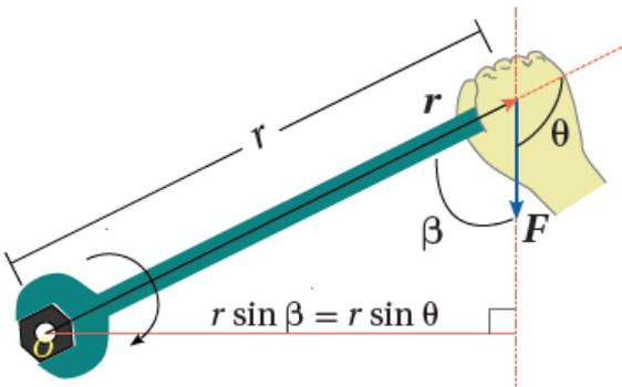
يستخدمُ زيد مفتاح شدّ طوله ( 25.0 cm ) لشد صامولة في درّاجة، حيث أثير بقوة مقدارها (  $1.6 \times 10^2 \text{ N}$  ) في طرف مفتاح الشدّ في الاتجاه الموضح في الشكل المجاور فإذا علمت أن مقدار الزاوية (  $\beta$  ) يساوي (  $75^\circ$  )؛ أحسب مقدار العزم المؤثر في المفتاح وأحدّد اتجاهه؟
